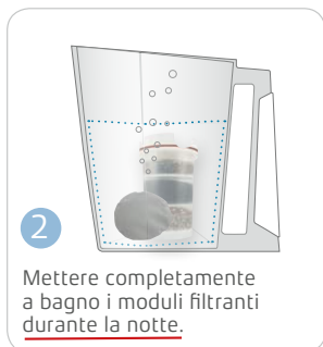
Filtri: pad anticalcare e cartuccia filtrante PI
